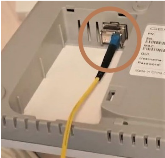
Abb. 6: Glasfaserkabel im SFP
